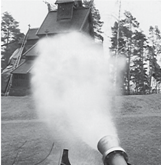
Teste de canhão de água, extintor de incêndio Foto: Pavel Jirásek
