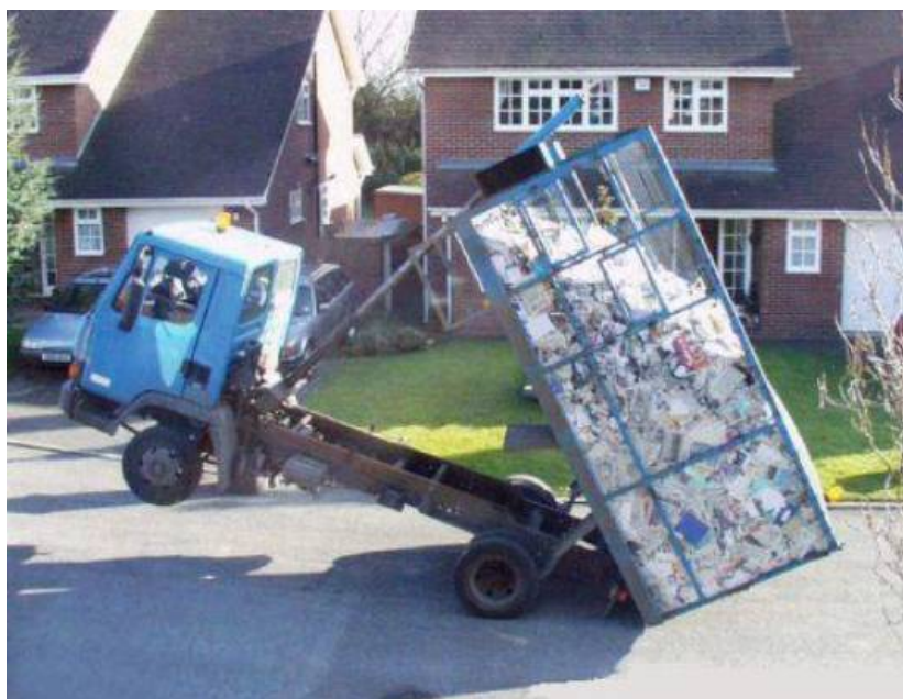
Queda do veículo transportador devido à falha da arrumação da carga
