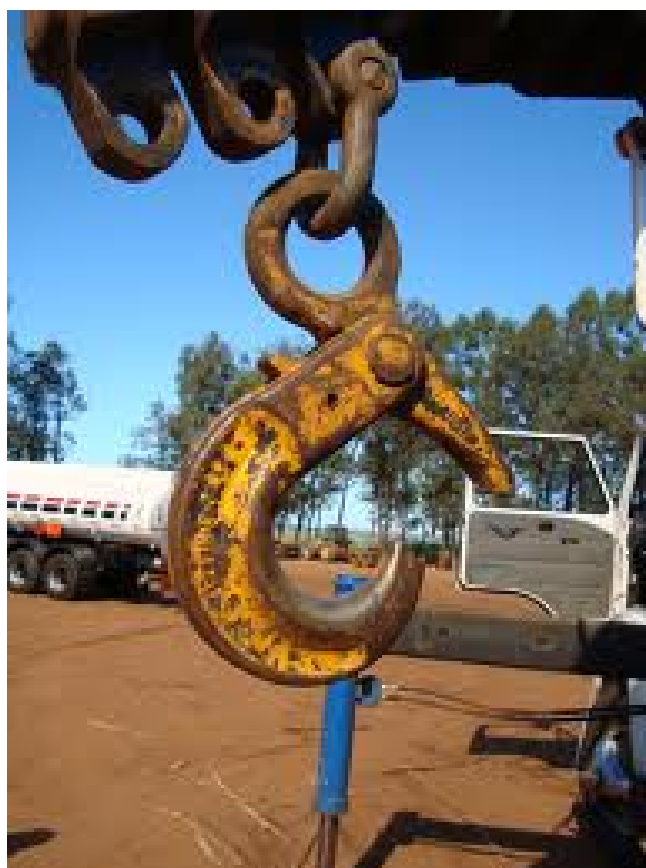
Acidente causado por falha na trava de segurança do gancho de içamento.
