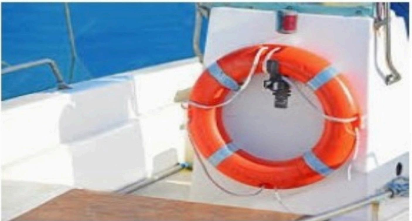
Dispositivo de Iluminação Automática - é obrigatória a adoção de dispositivo de iluminação automática associado a cada boia salva-vidas, com exceção das embarcações empregadas na navegação interior, que estão dispensadas de dotar esse dispositivo; e
