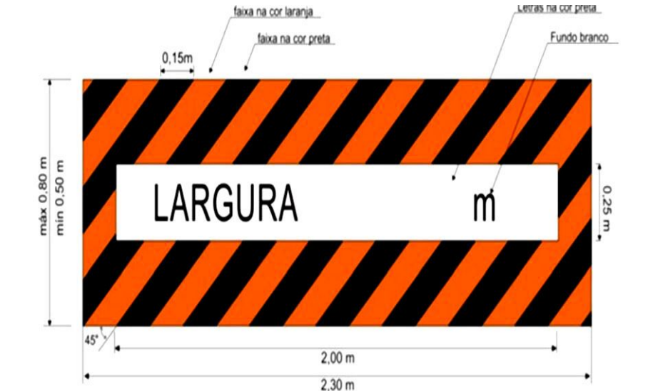
Figura 3: Sinalização especial de advertência traseira para largura excedente
