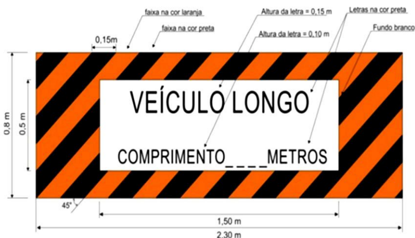
Figura 1: Sinalização especial de advertência traseira para comprimento
