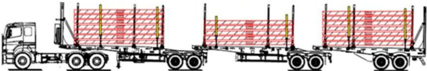
Figura 1: Configuração do CVR em viagem carregada
