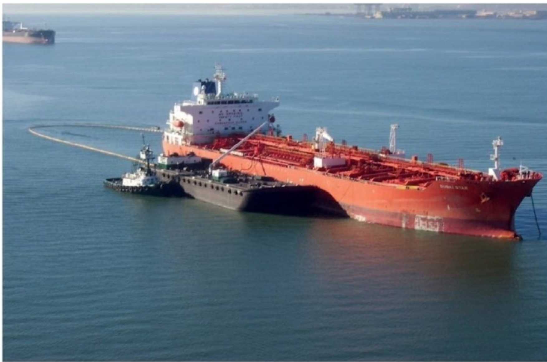
Figura 1 - Operação de abastecimento em fundeadouro ( Bunkering ).
