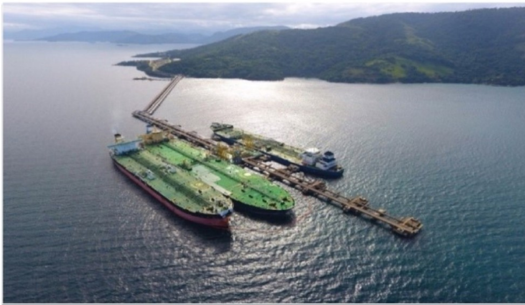
Figura 2 - Operação STS atracado em instalação portuária ( double banking ).
