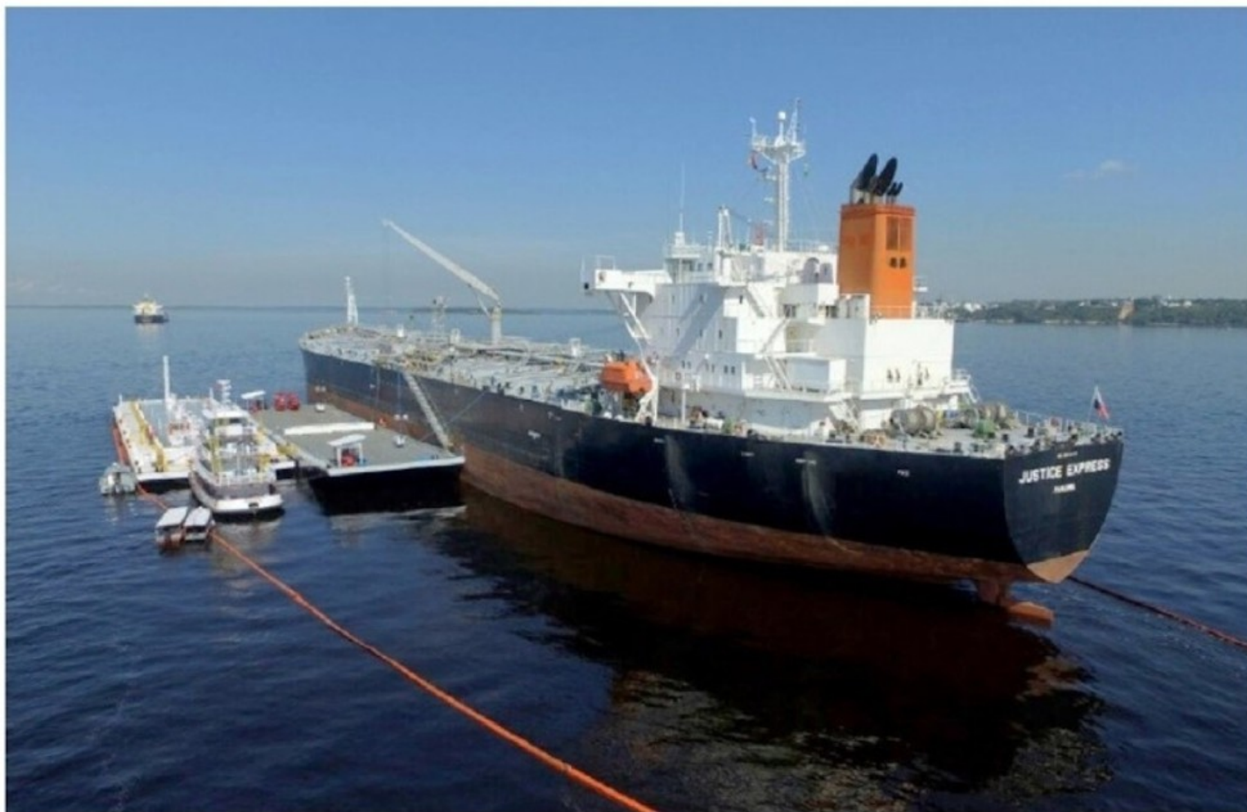
Figura 5 - Operação STB em fundeadouro de área portuária.
