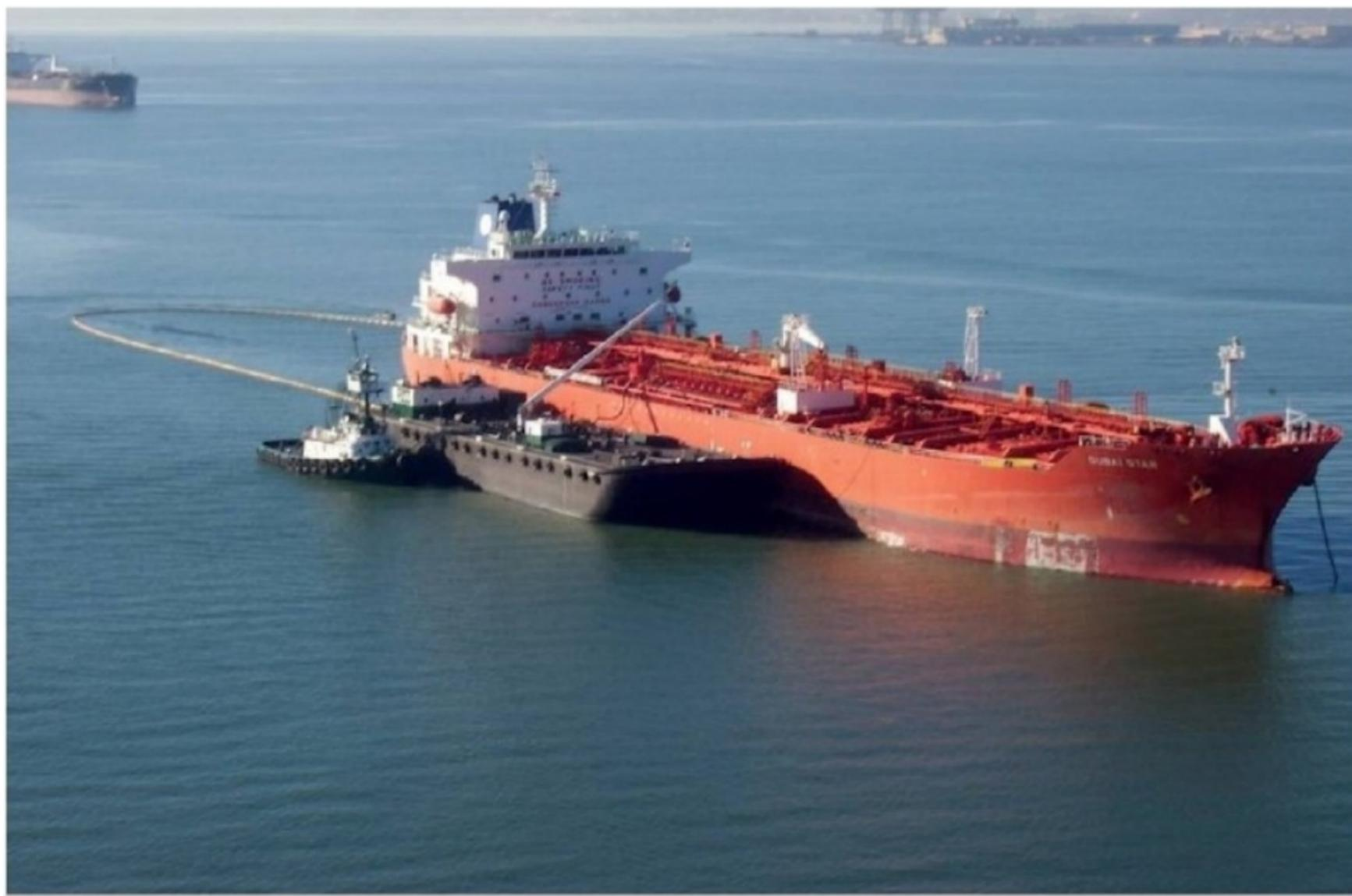
**Figura 1 - Operação de abastecimento em fundeadouro (Bunkering).**
