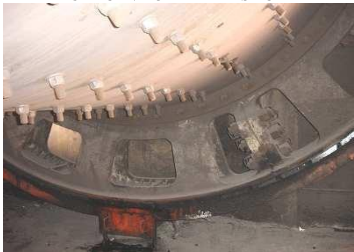
Figura 2 - Parte inferior do corpo tubular de moinho, destacando-se a coroa dentada de acionamento e os parafusos de fixação das blindagens internas, proteções contra a abrasão.
